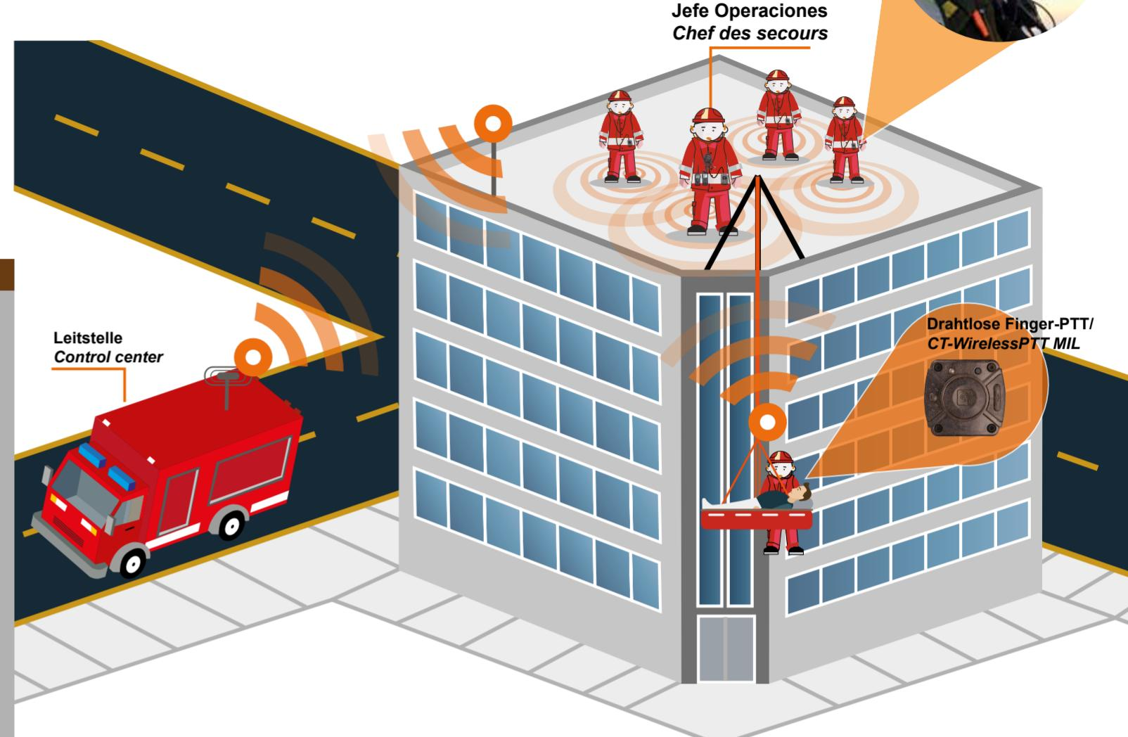
Como consecuencia de los obstáculos presentes puede fallar la conexión DECT. Para este caso existe una vía de transmisión adicional como respaldo. Para facilitar el manejo, el circuito de radio se puede activar simplemente a través del CT-WirelessPTT MIL, que también se puede llevar, por ejemplo, como PTT táctil.
